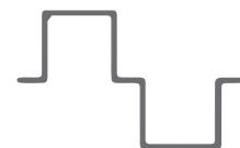
**MSW (Modified Sine Wave):** Các loại MSW tạo ra các sóng thay đổi, xen kẽ. Thích hợp để sạc hầu hết các thiết bị gia dụng và thiết bị điện tử, chẳng hạn như điện thoại, máy ảnh, máy tính xách tay và hệ thống chiếu sáng.
