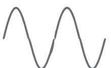
**PSW (Pure Sine Wave):** PSW là loại cung cấp điện áp ổn định, chất lượng điện lưới. Loại này có thể cấp nguồn cho tất cả các thiết bị, ngay cả những thiết bị dễ bị hỏng nhất (đèn neon, TV và PC, v.v.).
