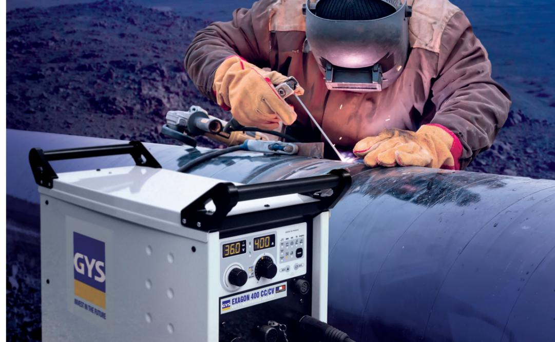
L'unità offre una maggiore produttività durante il suo ciclo di lavoro elevato (400 A al 60%) e un raffreddamento ottimizzato grazie alla ventilazione a tenuta d'aria che aiuta a isolare i componenti elettronici da sporco e polvere, tutti fissati in un involucro progettato IP23 robusto.
