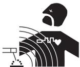
A corrente elétrica que passa por qualquer condutor produz campos elétricos e magnéticos (EMF) localizados. A corrente de soldadura, gera um campo electromagnético em torno do circuito de soldadura e do material de soldadura.
