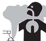
Os fumos, gases e poeira emitidos pela soldadura são perigosos para a saúde. Ventilação suficiente deve ser fornecida, a entrada forçada de ar é às vezes necessária. Uma máscara de ar fresco pode ser uma solução em caso de ventilação insuficiente. Verifique se a sucção é eficaz, verificando-a com os padrões de segurança.
