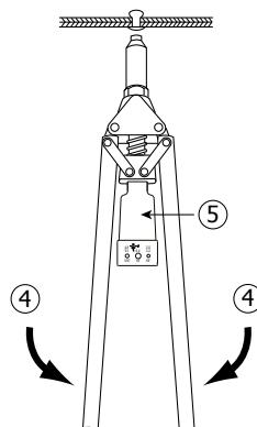
3 - 将铆钉枪手柄完全打开, 将铆钉芯塞入焊枪导嘴中。
