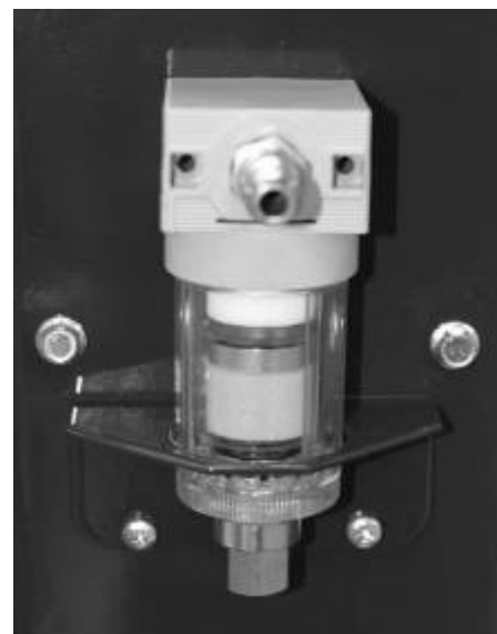
空気フィルターの後方に空気コネクターを取り付けます。
