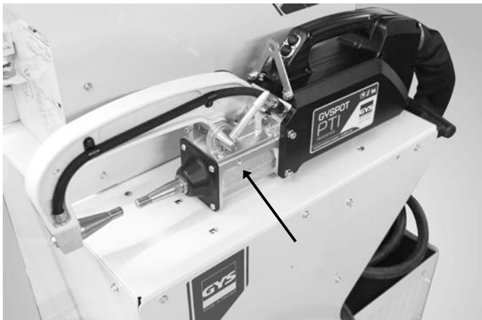
クランプの左側にクランプハンドルを取り付けます。
