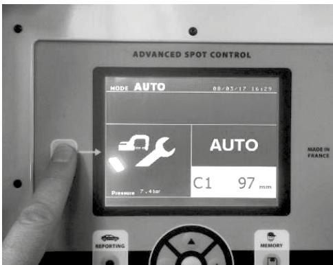
Presser le bouton « ESC » pour entrer en mode maintenance, ce qui a pour effet d'arrêter la pompe, si elle est en fonctionnement.
