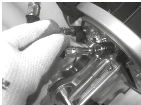
Koppel de slang van de koelvloeistof af. Koppel in de plaats daarvan de slang van deze kit aan.
