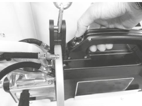
Presser le bouton supérieur de la pince pour activer la pompe. Le liquide s'écoule pendant 2 minutes, puis la pompe s'arrête automatiquement. Presser de nouveau ce bouton lorsque la pompe s'arrête, pour continuer de vider le réservoir. Il faut compter 20 à 30 minutes pour vider complètement les 30 litres du réservoir.
