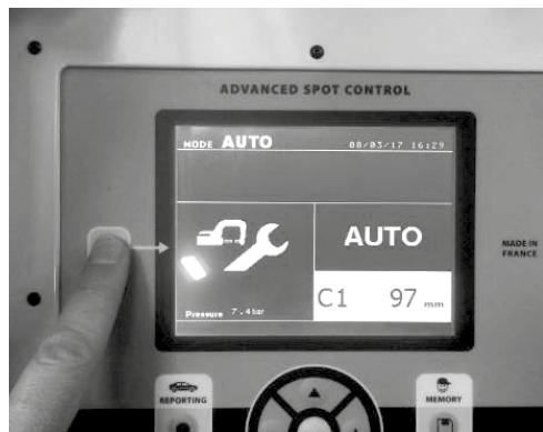
Druk op de knop « ESC » om toegang te krijgen tot de onderhouds-module, dit zal de pomp stoppen indien deze in werking is.
