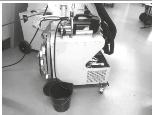
Lasciar ricadere il tubo di purgatura in un secchio sul lato della macchina.
