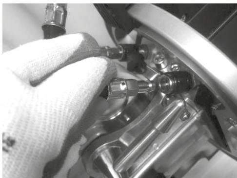
Scollegare il tubo del liquido di raffreddamento lato leva di bloccaggio dei bracci. Collegare il tubo del kit di purgatura in posizione.
