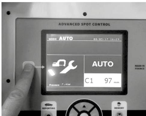
Premere il pulsante « ESC » per inserire la modalità manutenzione che ha per effetto l'arresto della pompa se essa è in funzionamento.
