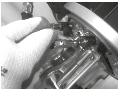
Entkuppeln Sie den Schlauch für die Kühlflüssigkeit auf der Seite des Spannhebels. Schliessen Sie stattdessen den Schlauch des Kits an.
