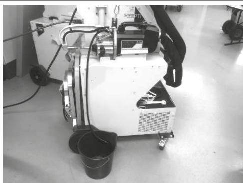
Führen Sie den Schlauch für die Kühlflüssigkeit in einen Eimer neben der Maschine.
