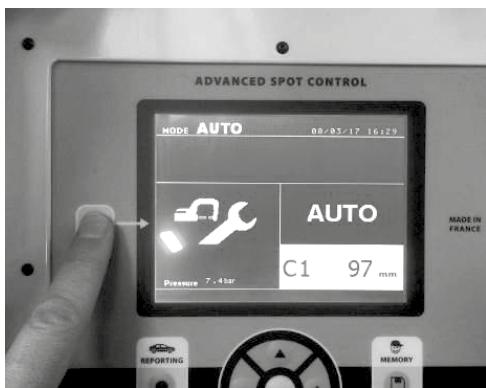
Drücken Sie die Taste « ESC », um den Wartungs-Modus aufzurufen. Dies stoppt die Pumpe, falls sich diese in Betrieb befindet.
