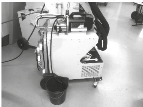
Laisser retomber le tuyau de purge dans un seau sur le côté de la machine.
