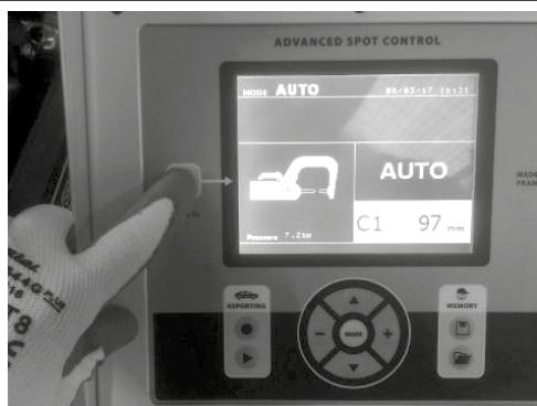
Premere di nuovo il pulsante « ESC » per tornare in modalità saldatura.
