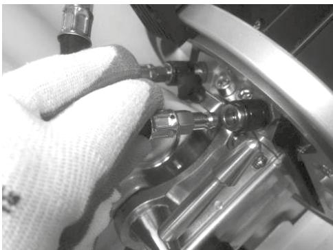
Déconnecter le tuyau de liquide de refroidissement côté levier de serrage des bras. Connecter le tuyau du kit de purge à la place.
