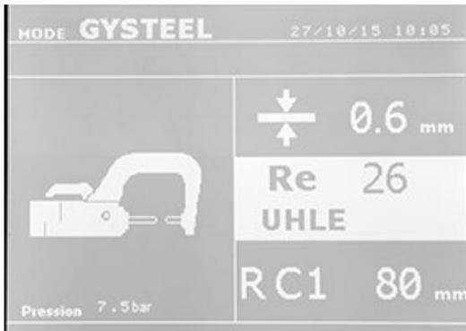
Le mode Gysteel est optionnel, il est configurable dans le menu réglage qui est activé en appuyant pendant 2 secondes
