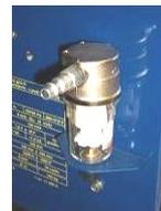
Filtre pneumatique, raccordement du réseau pneumatique
