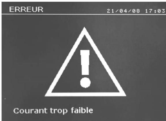
Si le courant obtenu pendant le point est inférieur à la valeur de consigne (6 %), la machine indique une fois le point effectué un message d'avertissement « courant faible » indiquant que le point est à vérifier.
