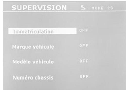
Lorsque la carte SD « identification » est insérée et que l'on sélectionne « identification ON » alors l'écran de supervision suivant s'affiche.
