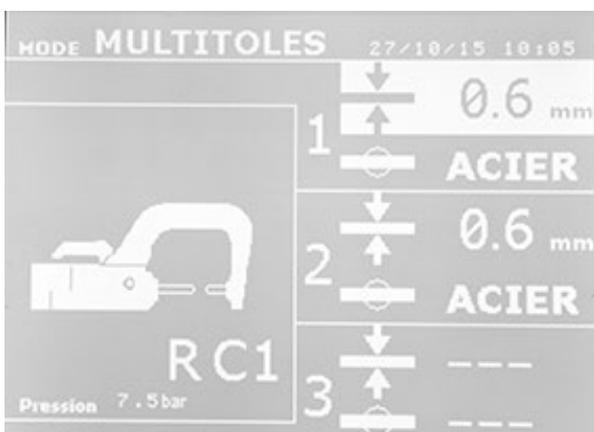
Le premier élément (épaisseur de la tôle 1) est sélectionné. Les touches haut et bas permettent de sélectionner le paramètre à modifier, tandis que les touches droite et gauche décrémentent et incrémentent sa valeur. La surbrillance permet de sélectionner le paramètre à modifier.
