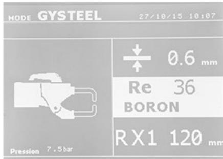
Ce mode Gysteel est identique au mode normal sauf que l'utilisateur saisit la limite élastique des tôles. Ce Re peut être connu en utilisant un duromètre tel que le Gysteel Vision.
