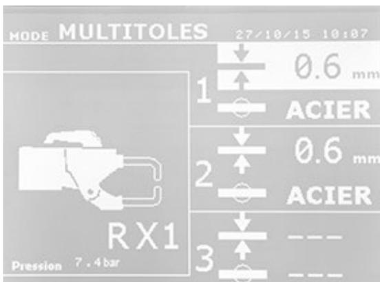
Le mode permet un réglage précis de l'épaisseur et du type de chacune des 2 ou 3 tôles.
