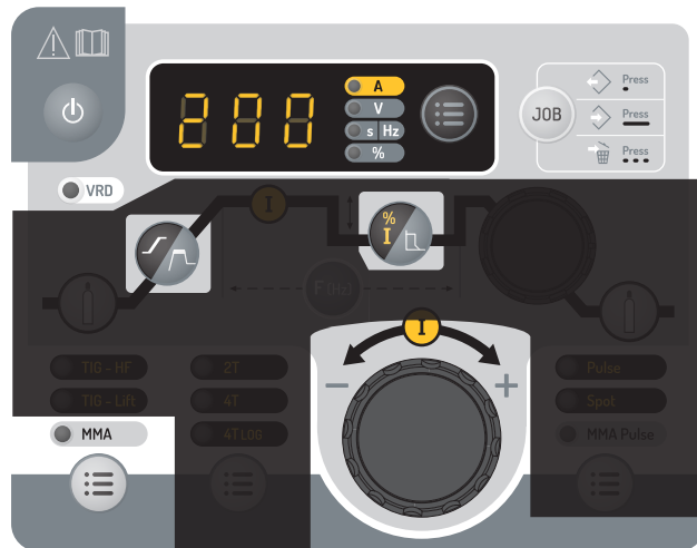
标准MMA焊接 灰色区域在此模式下无用。
