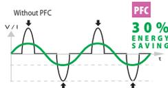
A tecnologia PFC suprime os picos e regula a corrente de alimentação. Também favorece a utilização de extensões ou grupo eletrogêneo e ajuda a obter uma melhor estabilidade da corrente durante a fase de soldadura.
