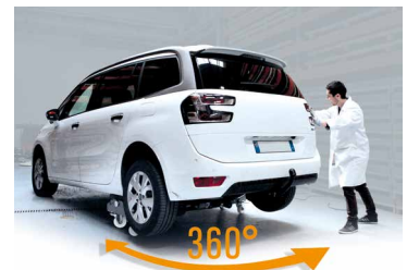
Räder zum einfachen Rangieren des Fahrzeuges (bis zu 360°)
