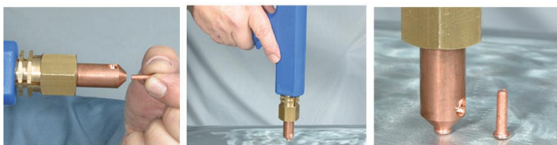
С помощью специального омедненного электрода (с магнитом для удержания привариваемого болта) можно приварить болты под резьбу или саморезы под пластик.
